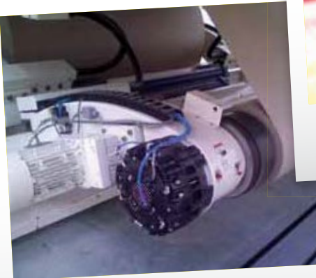
Freni Combiflex HP su svolgitore HP Combiflex brakes on unwinder
