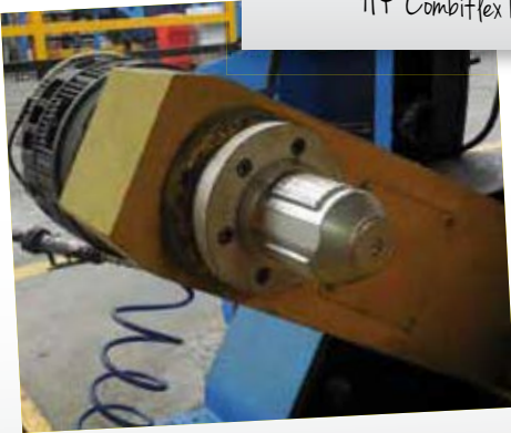
Testata Rotogrip monodiametrale su svolgitore Rotogrip monodiametral chuck on unwinder
